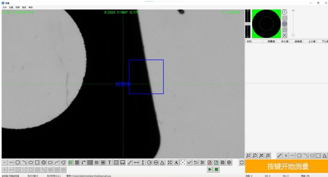
第五步：点击
